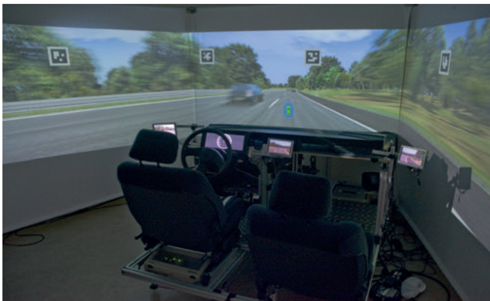
Abbildung 1: Konfiguration der Sitzkiste und des Simulator-Raums.
